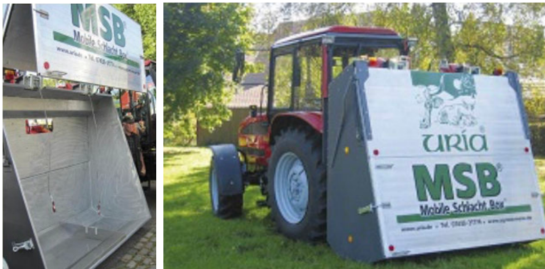
Afbeelding 4: Mobiele slachtbox van Uria © Uria e.V.
